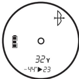
**Remarque:** Nous avons regroupé l'ensemble des fonctions les plus utilisées et les avons intégrées à un appareil simple à utiliser et ne comportant qu'un seul bouton. Ce télémètre laser fonctionne toujours en mode Tir à l'Arc sur une distance comprise entre 7 et 199 mètres. L'appareil affiche une distance de ligne de mire uniquement pour les objets acquis à plus de 199 mètres.
